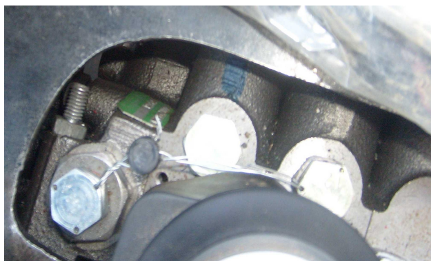
Рис.6 Пломбирование гидрораспределителя (в кабине, со стороны рабочего места оператора).
